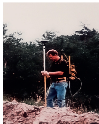
GPS (Global Positionerings System) indmåling af kabler via satellit
